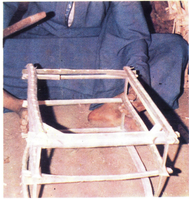
تركيب قوائم وعوارض القفص
