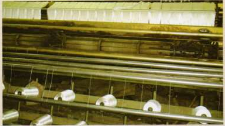
بكر خيط الحرير الصناعي الخام وهو يتحول في أولى مراحل تصنيعه إلى شتل
