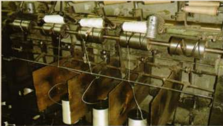
ماكينة برم مخصصة للخيط شديد الدقة تستخدم الحرير الطبيعي
