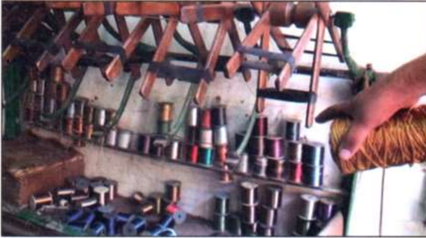
صورة (٢٢) (اللازونة) ماكينة تحويل الخيط من شكل الشل إلى شكل بكر
