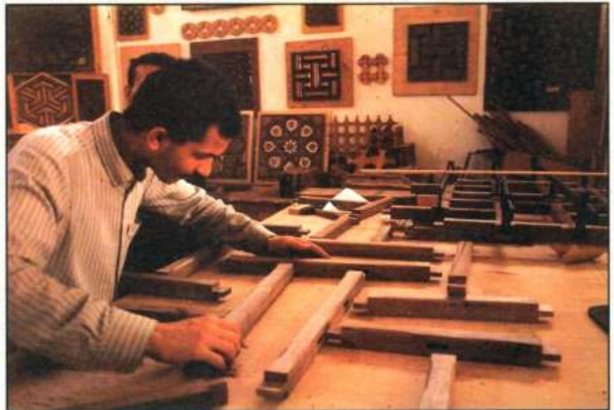
قسم التجارة التقليدية و يطلق عليها التجارة البلدى والعربى . و أساس هذه النوعية من التجارة هو التعشيقات والرسوم الهندسية
