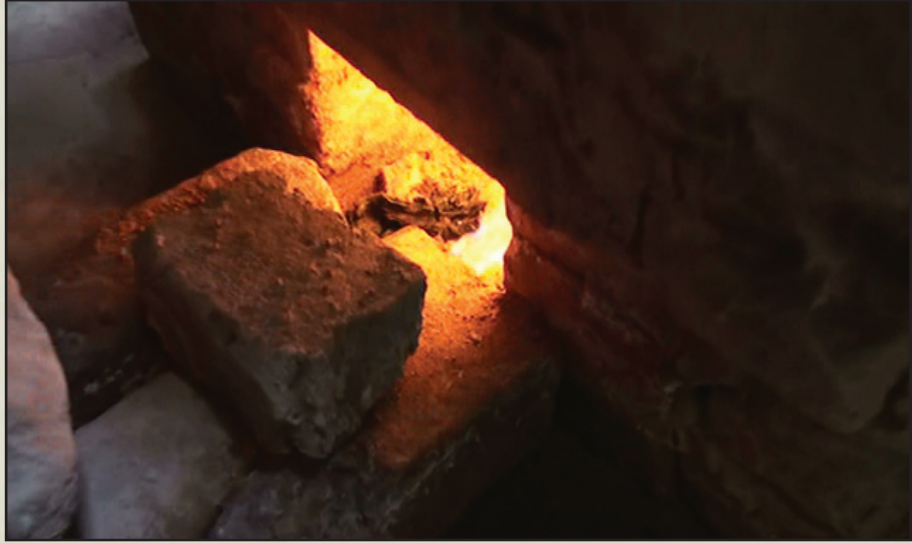
شكل (٦) بيت النار خلف الفرن والغاز والهواء مشتعلان بداخله
