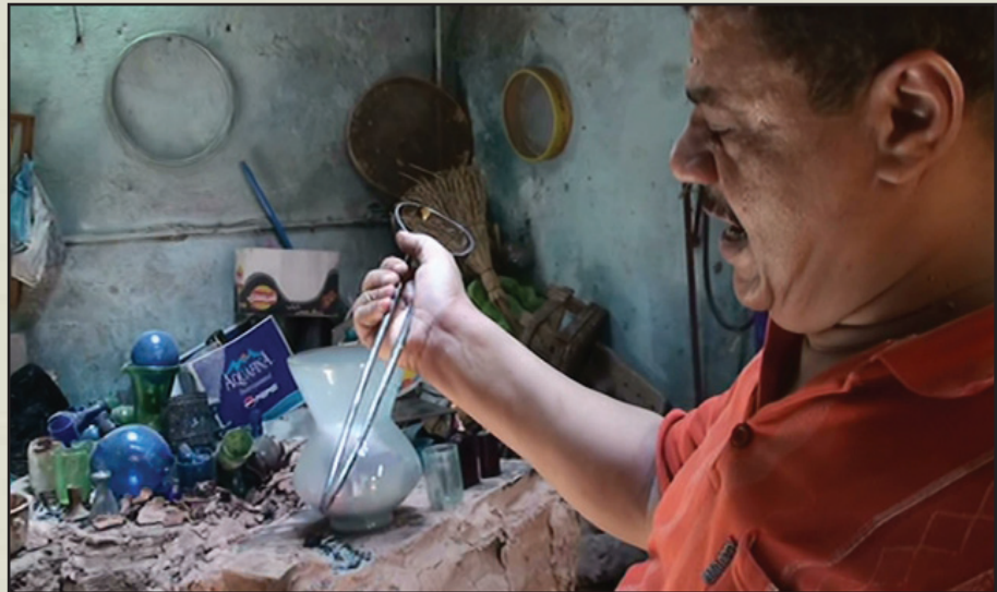
شكل (١٢) طريقة استخدام الماشة مغلقة لغلغ الشغلة
