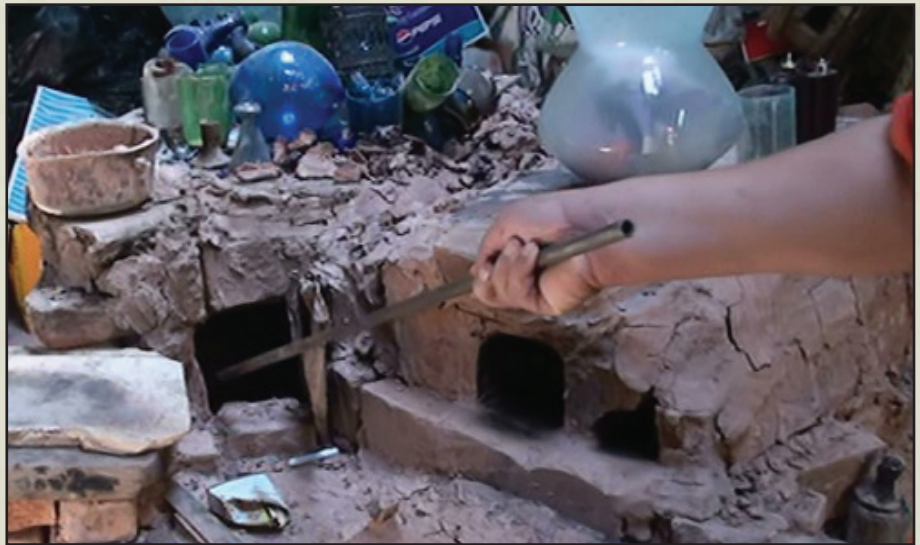
شكل (٢) المحمص ودرجة الحرارة بها ٨٠٠ درجة
