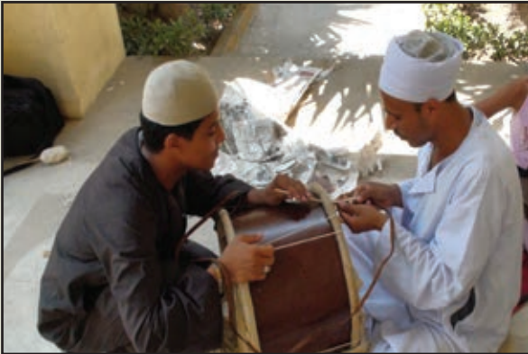
تثبيت الرق الجلدي بشد السيور الجلدية حول العلبة صورة رقم (٢١)
