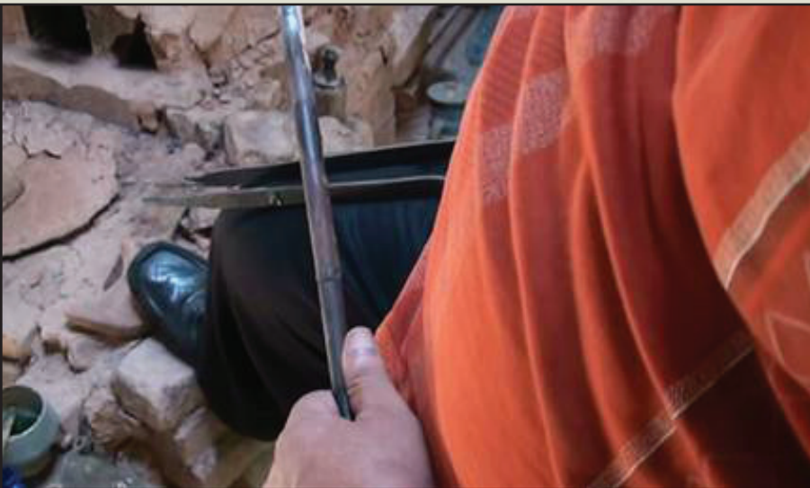
شكل (١٠) استخدام المربع الذي يوضع لحماية فخذ العامل
