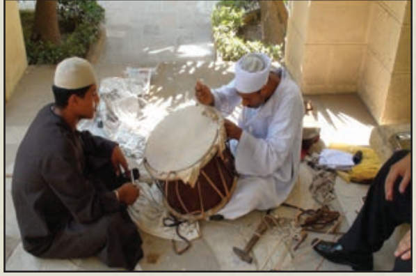
تثبيت الرق الجلدي على وجهي العلبة بإدخال السيور خلاله صورة رقم (٢٢)
