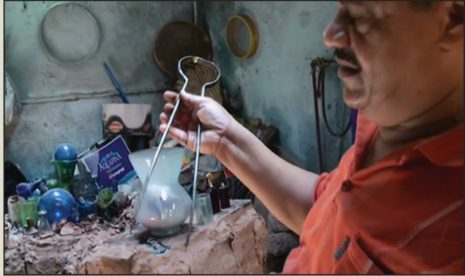
شكل (١١) طريقة استخدام الماشة مفتوحة لفتح الشغلة
