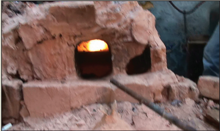
شكل (٧) اندفاع النار لأعلى ووصولها لبوتقة الصهر وخلفها بيت النار
