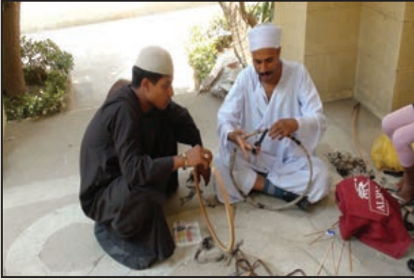
لف الإطار الخارجي (البتية) بالقماش وشرائط البلاستيك اللاصق صورة رقم (١٥)
