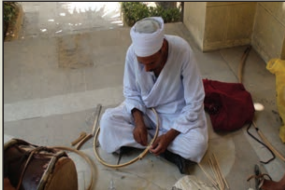
تجهيز الإطار الخارجي لشد الرق الجلدي صورة رقم (١٣)
